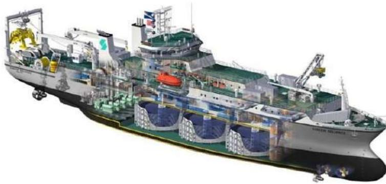
Figura 29: Embarcación instaladora de tipo Reliance Class de SubCom (Fuente: SubCom)
