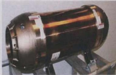
Figura 38: Vista del repetidor SubCom Amp-Quad (Fuente: SubCom)
