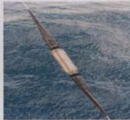
Figura 40: Vista del repetidor SubCom Amp-Quad (Fuente: SubCom)
