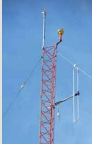
**Dipolos sumados en fase:** consta de varios dipolos simples alineados verticalmente (en el caso habitual de polarización vertical) a una distancia determinada. Usualmente, se colocan cuatro u ocho dipolos. Esta configuración produce un diagrama de radiación más plano, es decir que envía menos energía en ángulos elevados. Al aprovechar la energía más cerca del suelo, incrementa el alcance de la antena.
