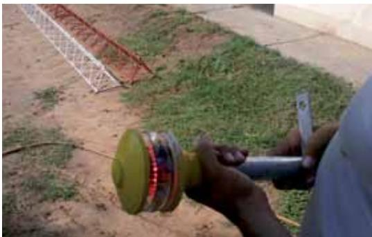
Los aisladores que se colocan en las riendas sirven para garantizar que el diagrama de radiación del sistema irradiante coincida con las indicaciones del fabricante y para desvincular las riendas eléctricamente tanto de la torre como de sus puntos de anclaje.
